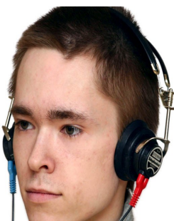
Figura 2. Correcta Colocación de los Transductores Supraurales TDH 39
